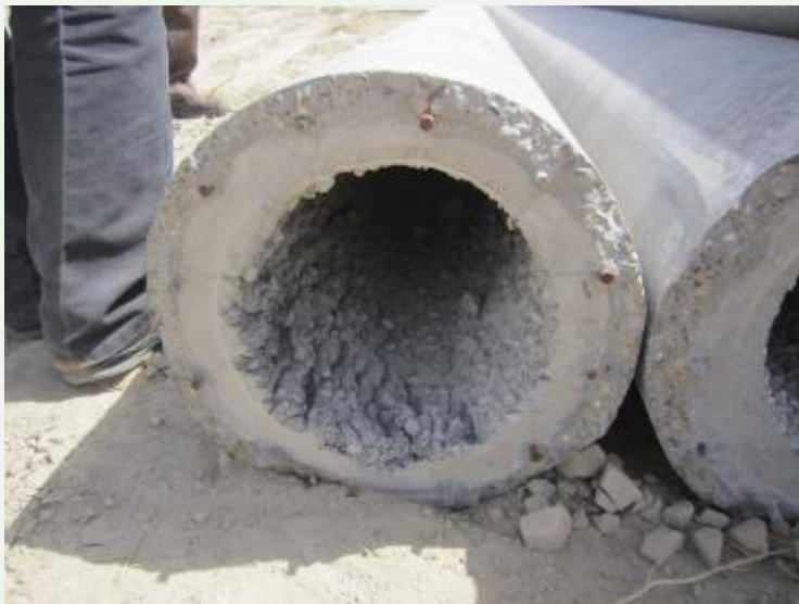
شکل ۶- عدم طراحی یا اجرای نادرست پایه‌ی بتنی (راست) و طرح اختلاط نامناسب و یا ساتریفیوژ با سرعت نامناسب در پایه‌های بتنی گرد (چپ)
