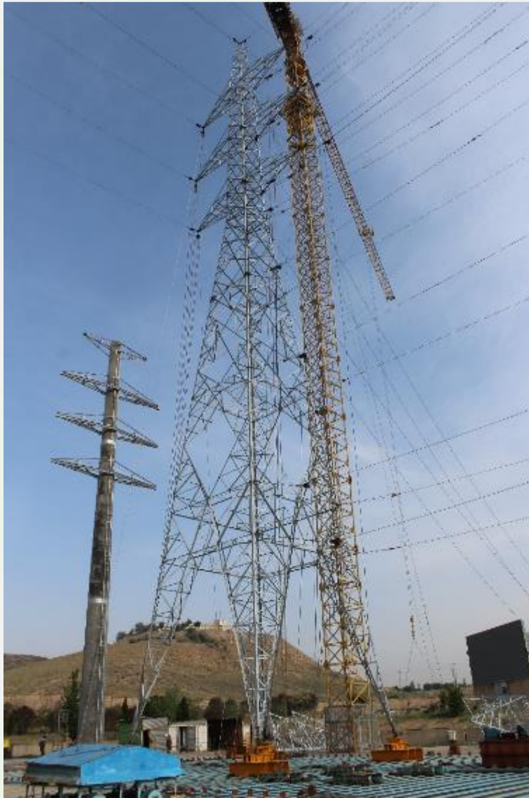
شکل ۳. دکل GLS-2 آماده آزمون و برج تلسکوپی بتنی A4T-60 آماده ریگینگ
